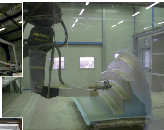
En service depuis juin 2005 un robot assure la projection de la résine après l'opération de thermoformage. L'opération se déroule intégralement en cabine fermée.
