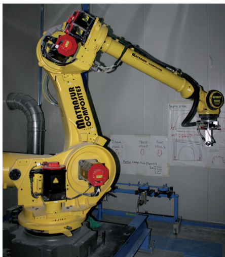
Opérationnel depuis début avril 2007 un nouveau robot assure le détourage des escaliers assurant ainsi l'intégralité de l'automatisation du process de production.
