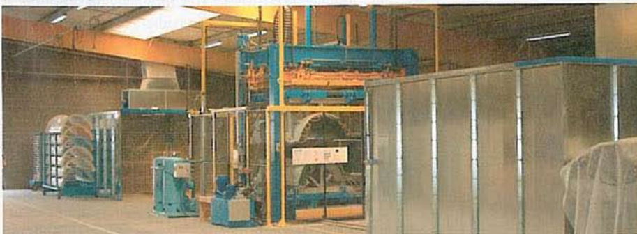
Alternative au moule ouvert, le procédé RTM injecte la résine dans un moule fermé. Il est plus complexe mais demande moins de main-d'œuvre.
