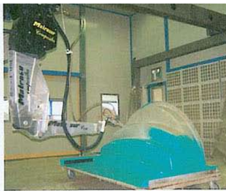
Robot pour la projection simultanée de résine et de fibres de verre chez Matrasur.
