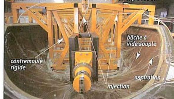
leurs trop beau. A chaque étape de la fabrication, des machines accompagnent les ouvriers lorsque ce n'est pas l'inverse. Même la pose des panneaux de tissu, dont la découpe est sous-traitée, est repérée par des faisceaux laser indiquant contours et références de la pièce. Le plus spectaculaire reste bien sûr l'injection automatisée avec coque et structure d'un même jet décrite plus haut. Mais il n'y a pas qu'elle.
