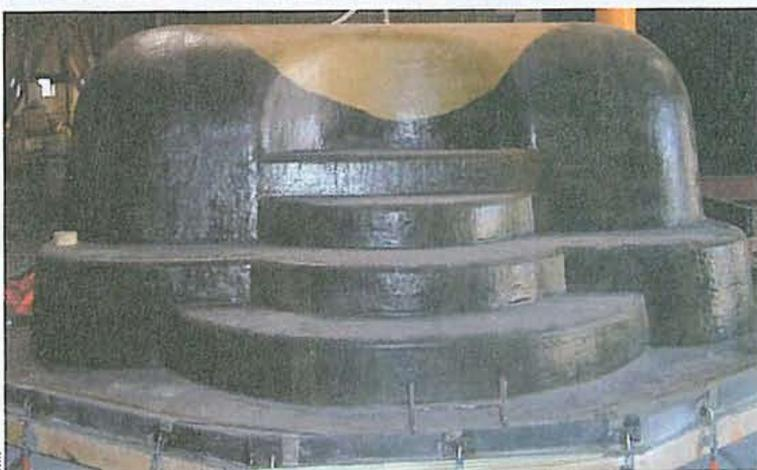
Thomas'Pools automatise la fabrication des coques de piscines en polyester. Après application d'un revêtement gel et de fibres de verre sur la surface d'un premier moule, on le referme à l'aide d'un contre-moule translucide. Il ne reste plus qu'à injecter le polyester en continu sous une pression de 2 bars. Une fois la matière
