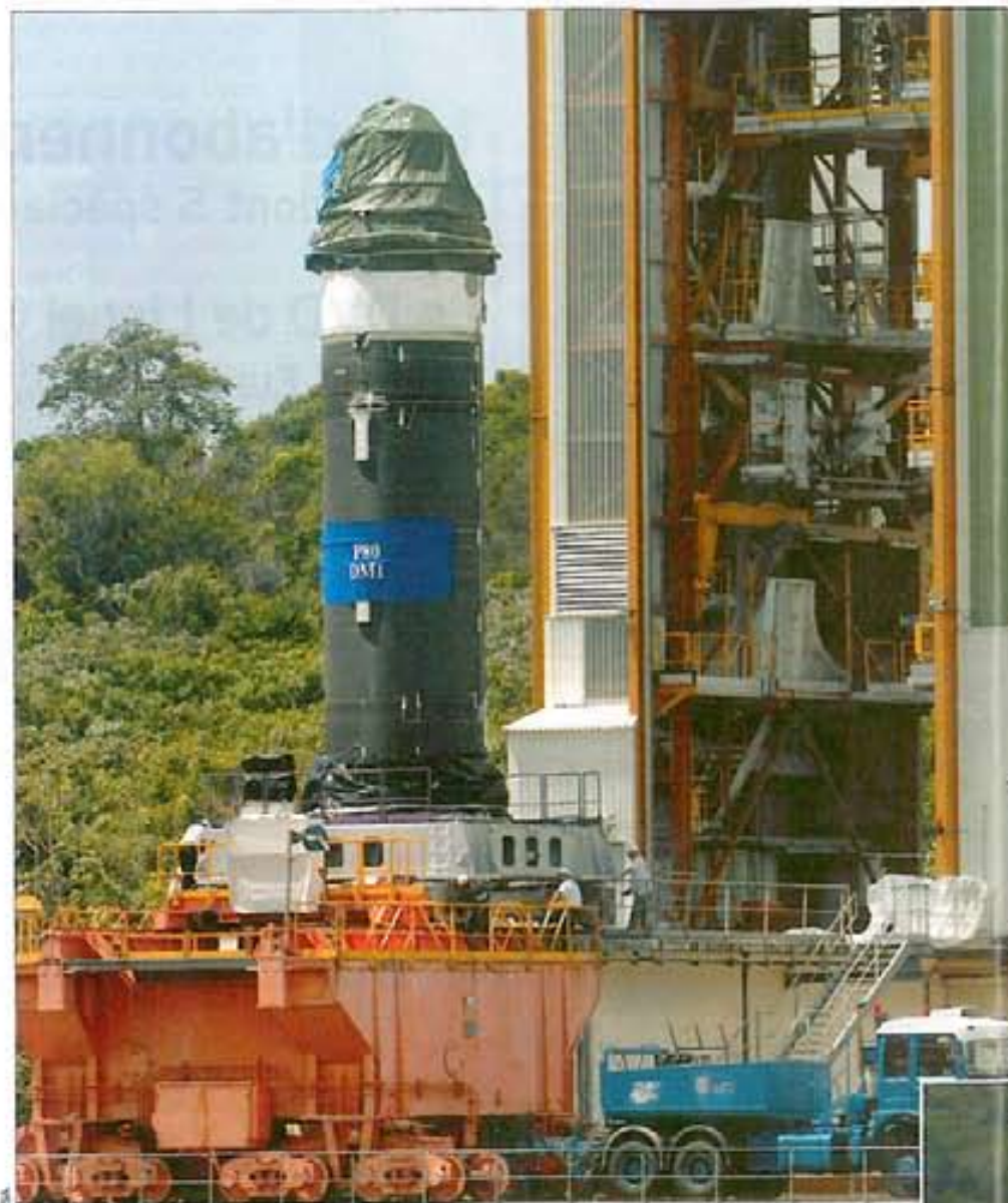
Le P80 sur son banc de tir. Il a délivré une poussée moyenne de 190 tonnes pendant 100 secondes (en médaillon).
