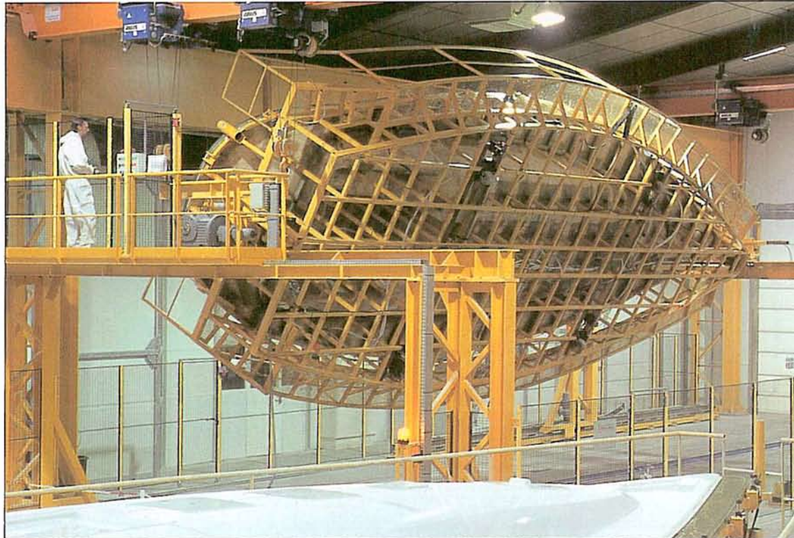
Machines. L'utilisation de moules rotatifs renforcés suppose de lourds investissements.
