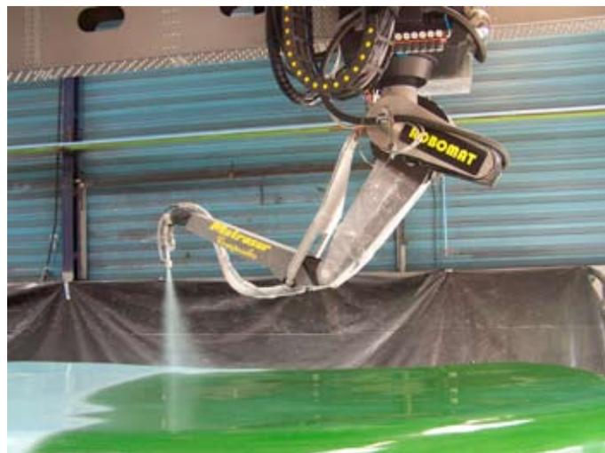
Рис. 8. Нанесения роботом гелькоата на поверхность формы.
