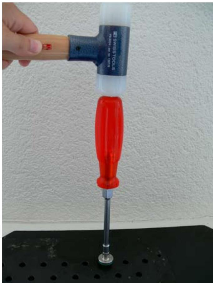
Рис. 2. Приспособление для монтажа вставок в соединяемые элементы конструкции из композитов.
