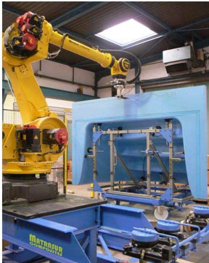
Рис. 10. Обрезка изделия на роботизированном стенде.
