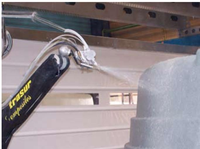
Рис. 9. Нанесение смолы и рубленого стекловолокна роботом на поверхность формы.
