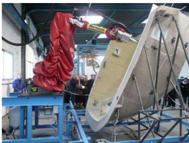
Фото 8. Механическая обработка изделия роботом Usimat в автоматизированном режиме.
