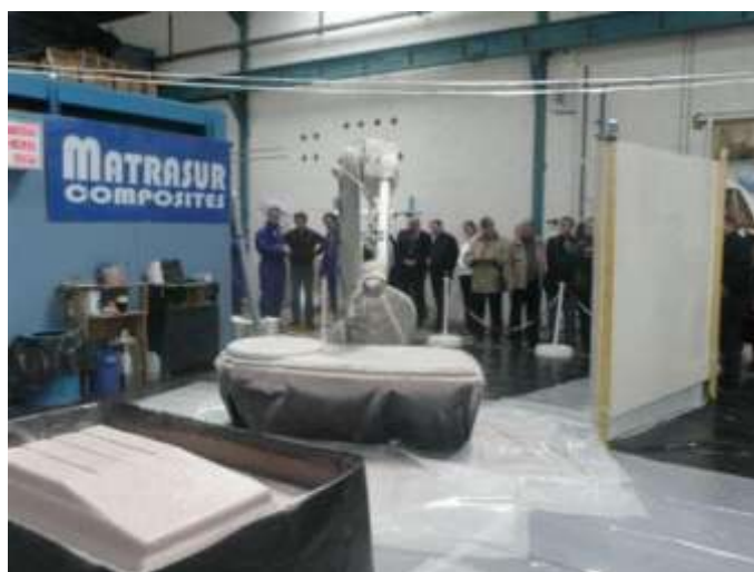
Фото 6. Процесс напыления роботом смеси смолы со стекловолокном на форму в автоматизированном режиме.
