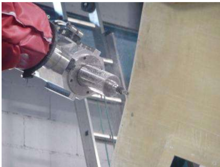
Фото 8. Головка робота Usimat в процессе обработки изделия по контуру.
