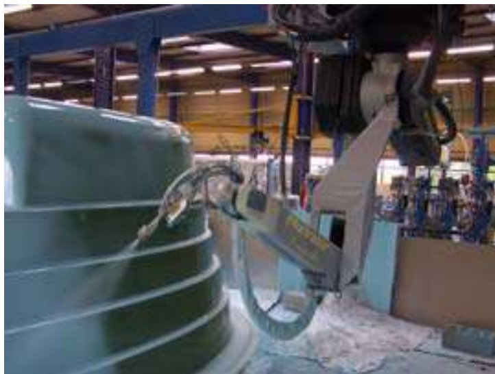
Фото 5. Робот напыляет гелькоут на форму в автоматизированном режиме после выполнения процесса оператором.
